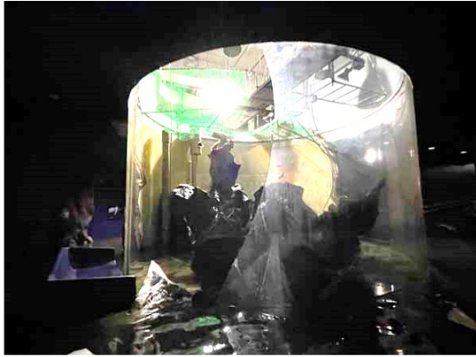
図4 ビワコオオナマズ水槽の状況(破損直後)
