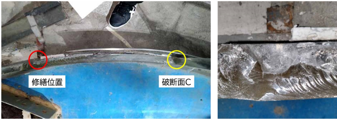
図18 A: 修繕箇所と破断面の位置関係(左)。赤丸が修繕位置。黄丸が破断面Cの下端でステンレス中木がアクリルに食い込んでいた位置。B: 2004年の削り取り跡
