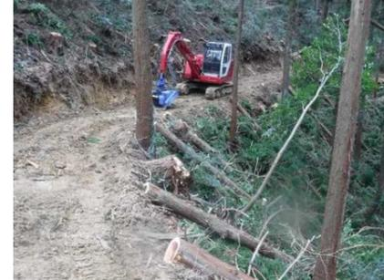
高性能林業機械による効率的な造材を意識した集材状況(元口を作業道に向けて集材)
