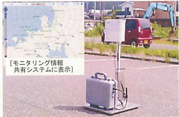
写真⑧ 可搬型モニタリングポストによる測定
