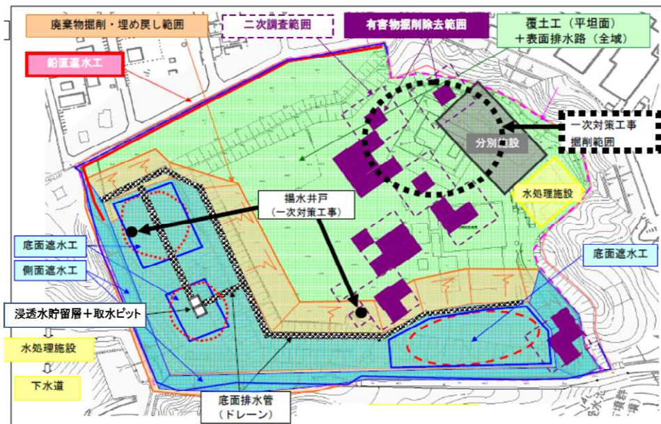
図2-16 二次対策における対策工事概念図
