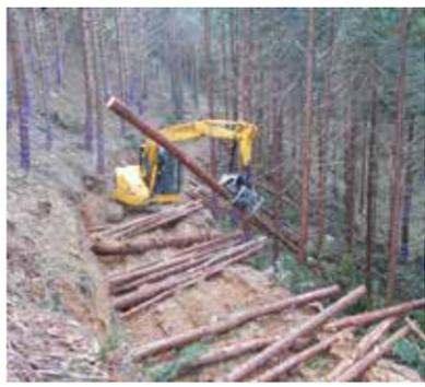
間伐作業(プロセッサによる造材作業)
