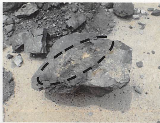
図) 重金属含有土の発生状況〔左：鏡面の状況、右：黄鉄鉱を含む岩塊〕※囲った部分で黄鉄鉱を確認
