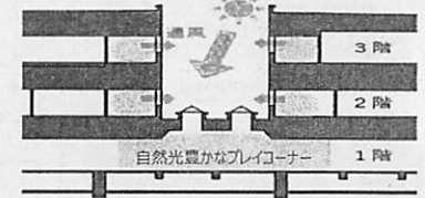
トップライトによる自然採光と自然換気
