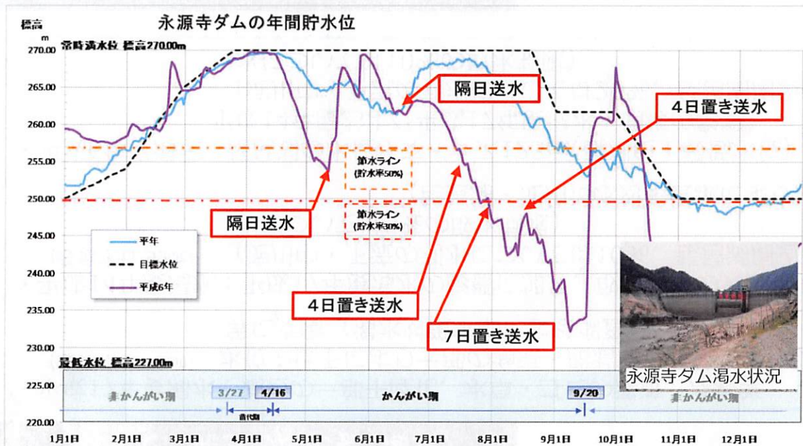
平成6年(渇水年) 永源寺ダムにおける送水制限(節水) の状況
