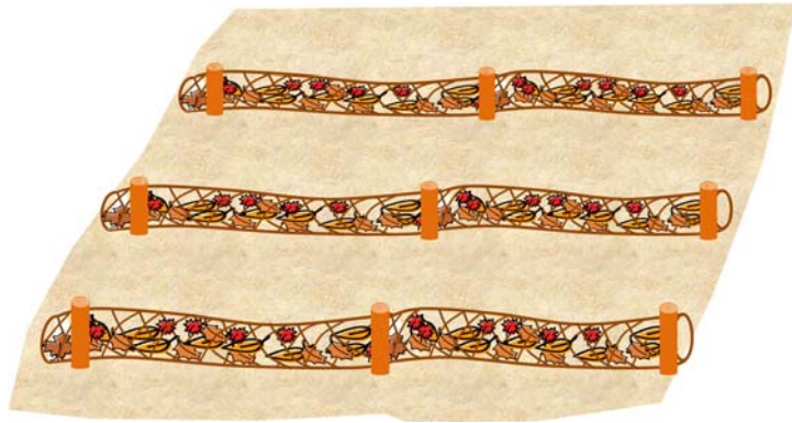
図 4.1.4 ヤシ繊維ネットロール筋工
