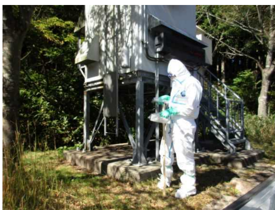
NaI シンチレーション式サーベイメータ による空間線量率の測定
