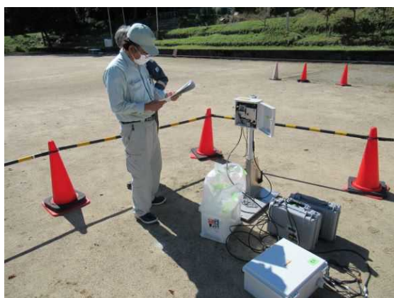
可搬型モニタリングポストの設置
