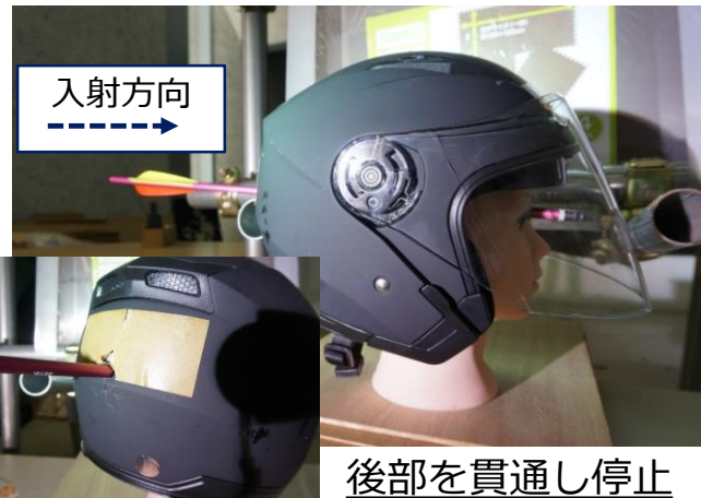
科学警察研究所における実験 (合成樹脂製ヘルメットに対する射撃実験)
