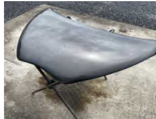
改質リグニン樹脂を用いた炭素繊維強化材を使用した自動車用外装材ボンネット(試作品) (写真提供:(株)宮城化成、国立研究開発法人森林研究・整備機構)
