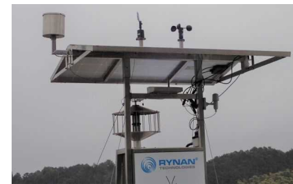
画像診断を用いた発生予察のための機器(予察灯)
