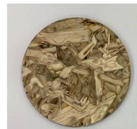
図6 ヨシを用いた建材
