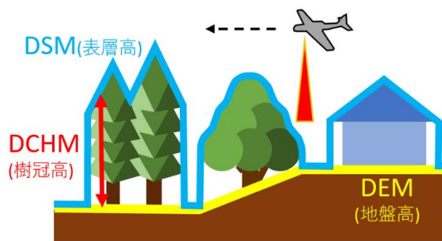
レーザ計測の仕組み
