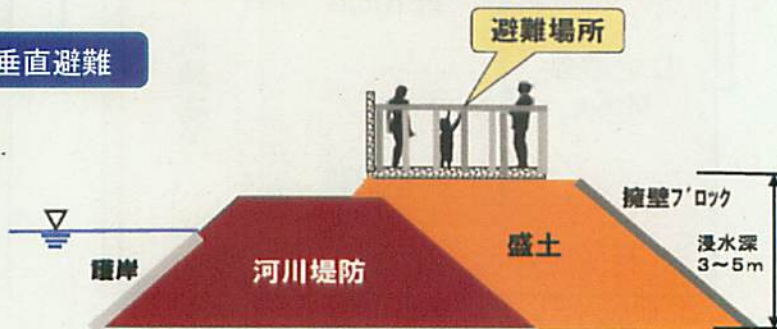
既設堤防腹付け盛土型避難場所
